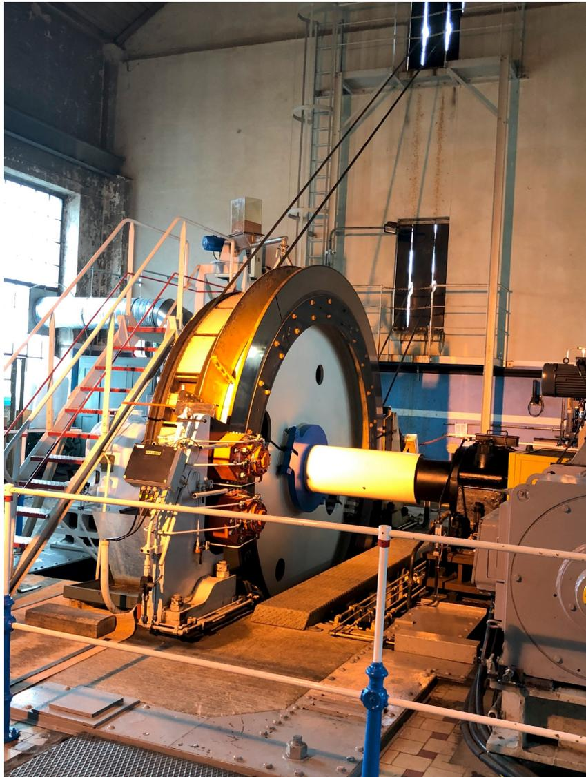
La máquina de extracción arrastra una jaula y su contrapeso. Es una polea Koepe, bicable de 27 mm de diámetro, con motor de 410 kw.
